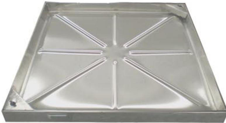
Tampa de visita com rebaixo de 25 mm para enchimento, realizada numa única peça estampada em aço inoxidável austenítico AISI 304 para maior rigidez e resistência à corrosão.
