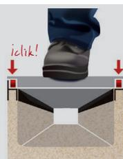
FECHO RÁPIDO DE SEGURANÇA, SEM PARAFUSOS. 8 fixações por metro linear.
